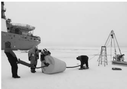
Рис. 2. Постановка вмораживаемого автоматического профилометра (ИТР) в экспедиции АВЛАП/NAVOS-2013. АНИИ
