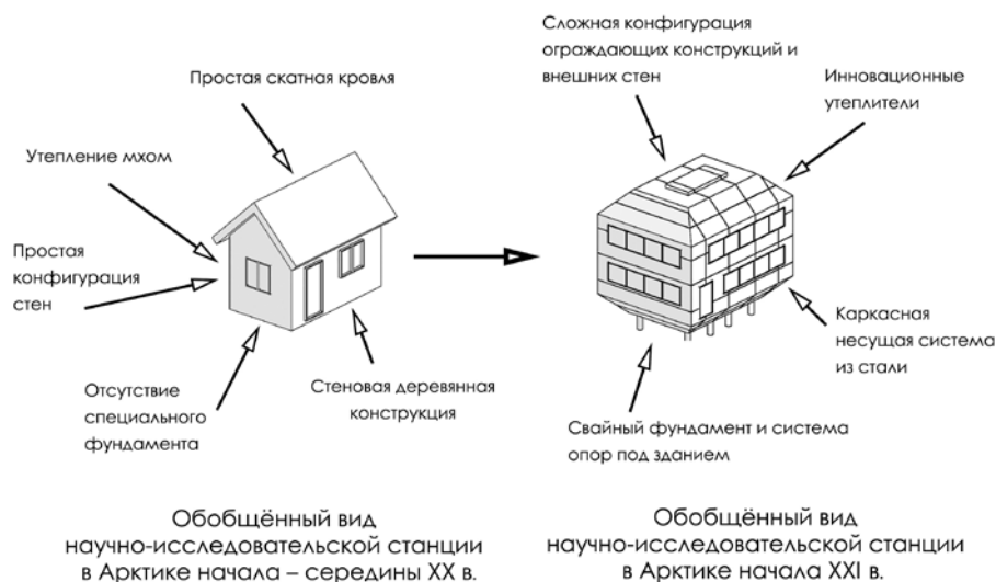
Рис. 2. Эволюция строительных технологий на примере архитектуры научно-исследовательских станций
