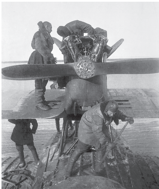
Рис. 5. Пилот В.В. Косухин и бортмеханик Б.Г. Крутский чинят кормовой мотор (в верхней части снимка). На переднем плане – один из членов экипажа очищает корпус самолёта от намерзшего льда. 1932 г. Фотограф С.В. Обручев. Архив семьи Обручевых
