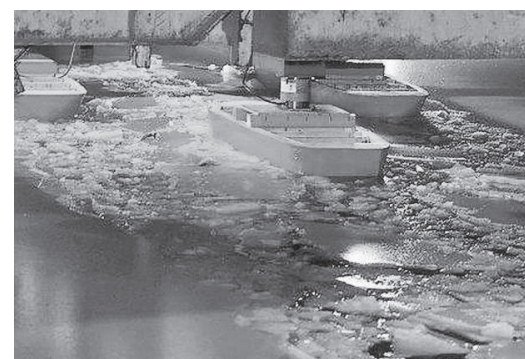
Рис. 4. Испытания модели 4-корпусного ледокола
