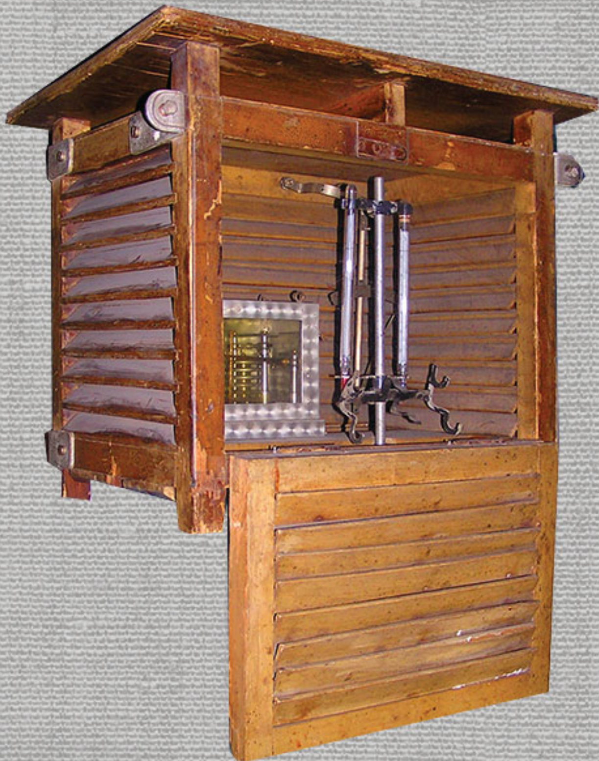
ПСИХРОМЕТРИЧЕСКАЯ БУДКА С ПРИБОРАМИ ДРЕЙФУЮЩЕЙ СТАНЦИИ «СЕВЕРНЫЙ ПОЛЮС»
