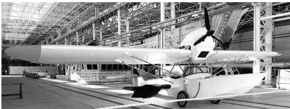
Фото 5. Самолет-амфибия Ш-2.017 бис, за основу при строительстве в качестве прототипа использовался самолет «Ш-2» находящийся в музее Арктики и Антарктики. Сегодня в цехах АО «СНЗ» он готов к летным испытаниям и уже проверен на остойчивость в воде 02.08.2019 г. 3 - https://www.youtube.com/watch?v=Dwelzo76fvE
